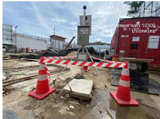
รูปที่ 53 ติดตั้งเครื่องตรวจวัดคุณภาพสิ่งแวดล้อม
