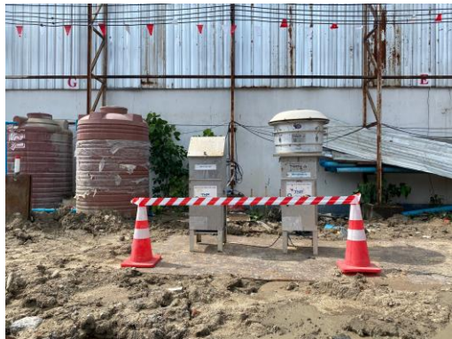
รูปที่ 53 ติดตั้งเครื่องตรวจวัดคุณภาพสิ่งแวดล้อม
